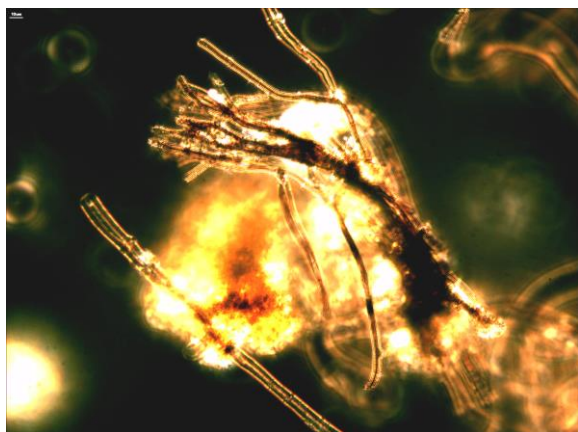
400-szoros nagyítás M/1 jelű anyagminta polarizációs mikroszkópos felvételei
